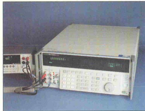
Die Referenz: für korrekte Spannung, Strom und Widerstand sorgte der Kalibrator Fluke 5700A.
